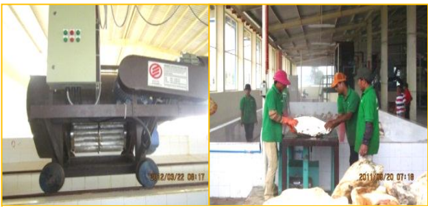
ម៉ាស៊ីនកៀប (Crusher) និងម៉ាស៊ីនកាត់ (Cutting machine)
