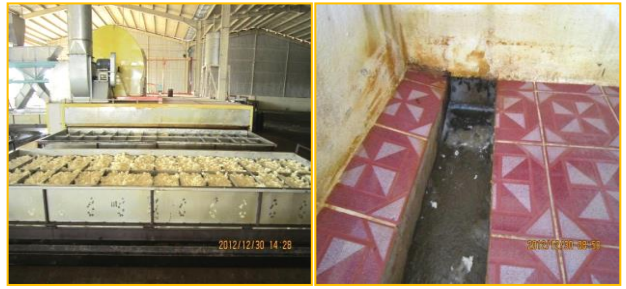
គ្រាប់ជីវសម្រក់ទឹកមុននឹងរុញចូលឲ្យសម្ងួត និងបន្ទប់ឲ្យសម្ងួតដែលមាននូវបញ្ចេញទឹក
