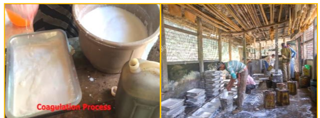
ការចាក់សូលុយស្យុងអាស៊ីតហ្វូរមិកចូលថាសបង្កទឹកជ័រ
