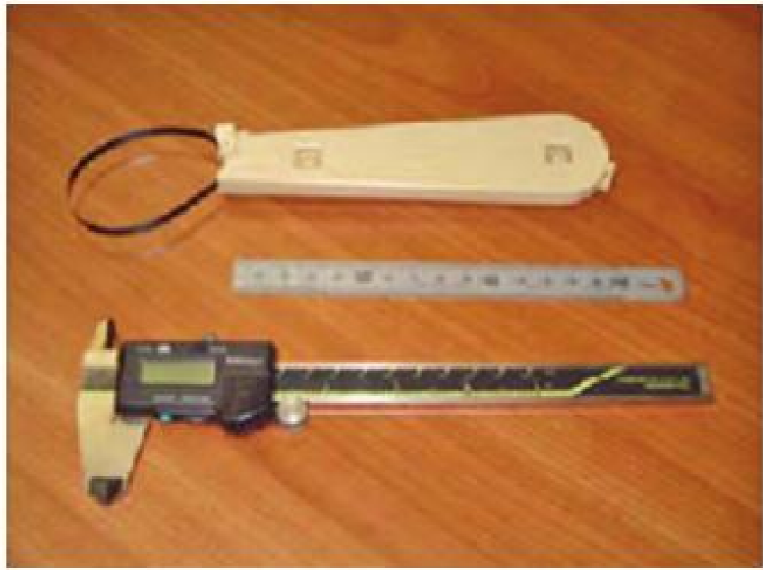
ឧបករណ៍ធ្វើសំរាប់ទំហំ ÷ ខ្នាតក្រឹត បន្ទាត់ ប្រពាយវាស់
